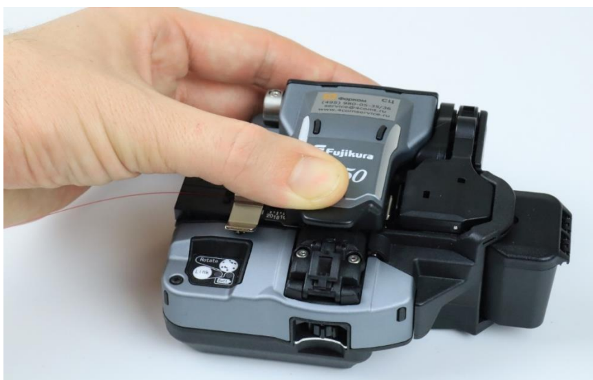
2.7 Сурет - Оптикалық талшықтан сынық алудың соңғы кезеңі
