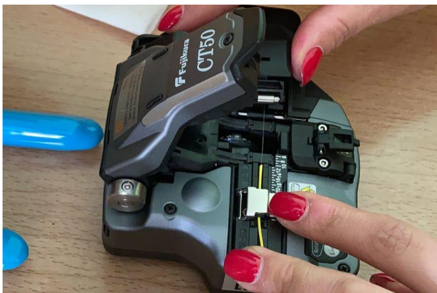
2.6 Сурет - Оптикалық талшықты кескіш Fujikura CT50.3-пен жұмыс
